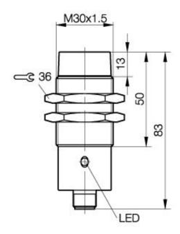
Induktiver Näherungsschalter BES 516-363-S 4-C M30x1.5 x 83 Schließer Sn=15mm nicht bündig einbaubar
